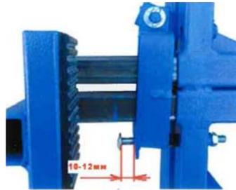
El mecanismo de sujeción suele estar en un estado ajustable, pero después de un tiempo, puede ser necesario un ajuste adicional de la abrazadera derecha.
