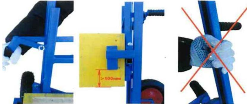
La altura de las abrazaderas debe estar por encima del borde inferior de la colmena (alojamiento) y no debe ser inferior a 100 - 150 mm. Sin mucho esfuerzo, esto garantiza un alzamiento más seguro.
